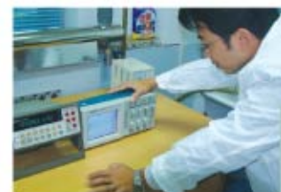
试验人员正在进行镇流器测试
