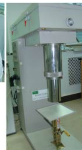
具有世界先进水平的紫外线平行光束仪
